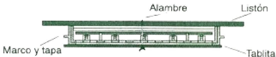
SISTEMA DE NIVELACIÓN CON LISTONES
